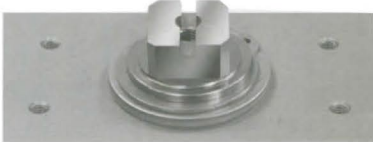
输出轴的NAMUR标准槽和缸体上部标准安装孔，可使限位开关、定位器直接啮合和安装。
